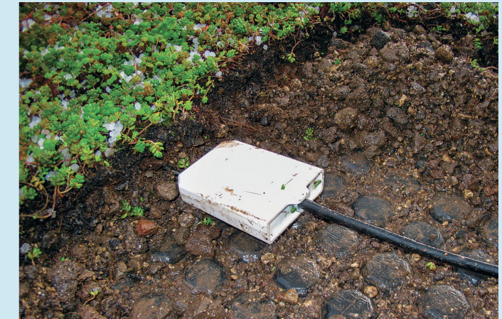
Bodemvochtmeter in substraat op groen dak 700 m 2 . (Foto: Stadsontwikkeling Rotterdam, T. van Hille)
