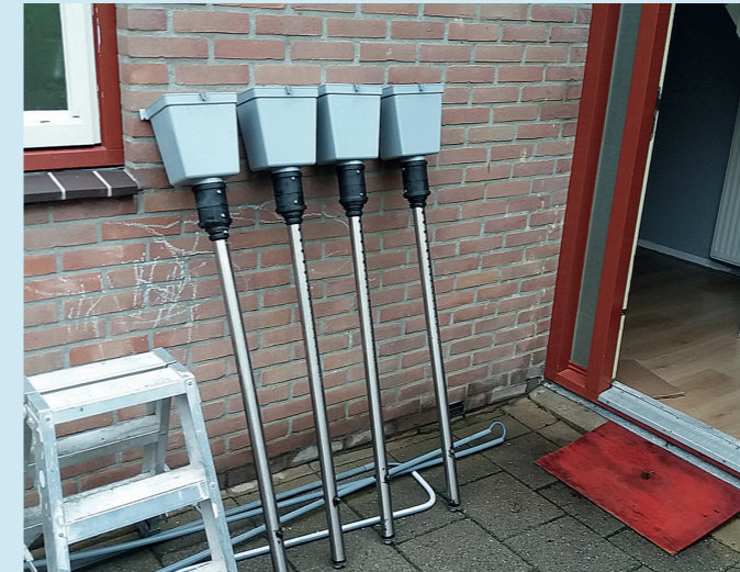
Afvoermeetbuizen met opvangbak. (Foto: Hendrikjan Teekens)
