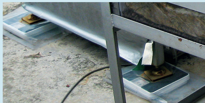
Gebruik van vier personenweegschalen om tweemaal daags het gewicht van de complete setup te meten. (Foto: Toine Vergroesen)
