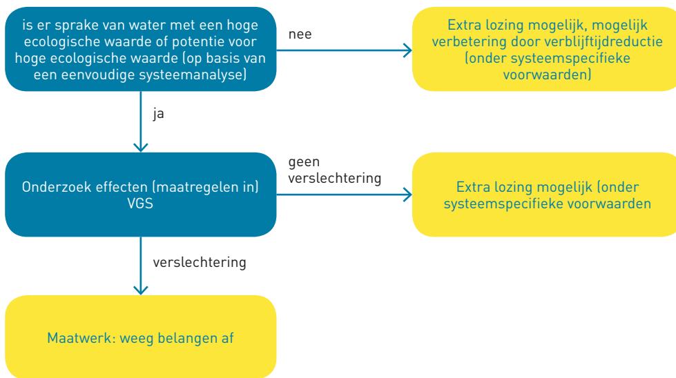
Figuur 5.1 Schema afweging belang extra hemelwaterlozing vanuit VGS voor kwaliteit oppervlaktewater (Bron: Fennema, 2017)
